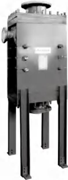
单侧可拆的矩形全焊接板式换热器，它继承了不可拆全焊接板式换热器的优点，即耐高温、高压，又避免了不开拆的缺点（不能打开清洗，只能CIP清洗，清洗不了或内漏了只能报废）。单侧可拆的矩形全焊接板式换热器单侧可打开清洗，材料和制造成本都比双侧开拆低，制造过程简单。产品内漏的话还可以封掉相应的流道之后，继续使用。
