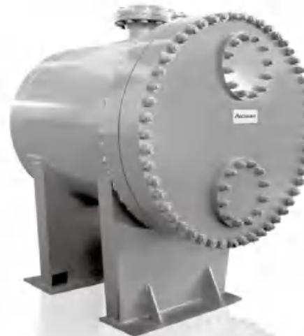
圆形全焊接板式换热器是一种新开发的高温高压、高效紧凑的新型换热器。它体积小，重量轻，安全可靠性高，经济性好。适用于列管所适用的大多应用场合，可替代列管而取得节能增产、节省投资，简化装置、安全可靠、技术进步的应用效果。最高操作温度600°C，最高设计压力10MPa。
