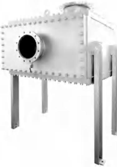
双侧可拆的矩形全焊接板式换热器，它继承了不可拆全焊接板式换热器的优点，即耐高温、高压，又避免了不开拆全焊接板式换热器的缺点(不能打开清洗，只能CIP清洗，清洗不了或内漏了只能报废)。内部设有限流装置，可保证两侧介质流动的近似逆流，两侧介质通道均可打开直接清洗。随着全焊接板式换热器的发展，双侧可拆的全焊接板式换热器具有广阔的市场前景。
